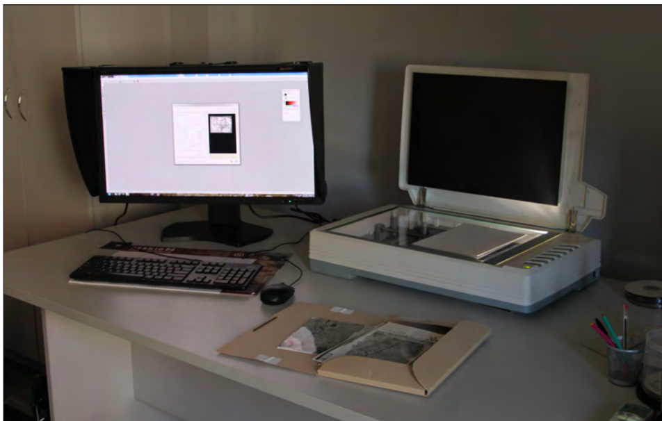
16. Skaner płaski A3 z zestawem komputerowym przygotowany do skanowania odbitek fotograficznych – Fot. M. Lupa.
