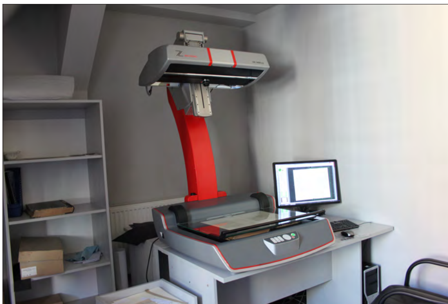
15. Profesjonalny skaner dzielowy formatu A3 przeznaczony do skanowania książek i porysów archiwalnych – Fot. M. Lupa.
